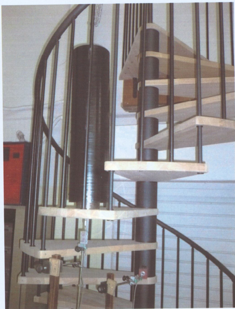
Particolare del carico e del posizionamento degli strumenti di misura (gradino 10°).
