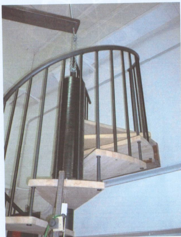
Fotografia del posizionamento del carico sul gradino 12°.
